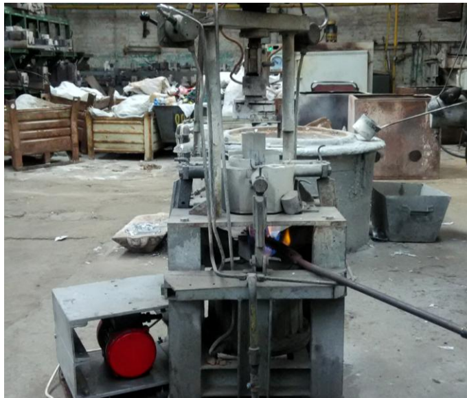
Рис. 1 Вибрационная обработка кокиля с отливкой в литейном цехе
