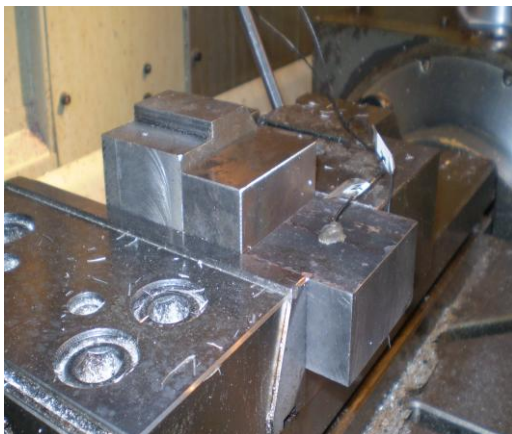
Рис. 1 Расположение вибродатчиков AP 2019 (по осям z и x ) на призматическом образце (слева) и настройка на выполнение рабочего хода фрезерования (справа) на станке мод. 500 V/5
