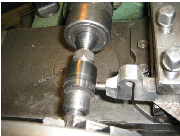
Рис. 3 Процесс выглаживания оправки
