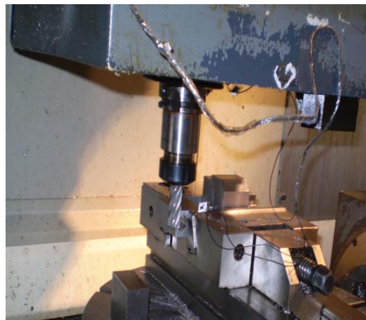
Рис. 1 Расположение вибродатчиков AP 2019 (по осям z и x ) на призматическом образце (слева) и настройка на выполнение рабочего хода фрезерования (справа) на станке мод. 500 V/5
